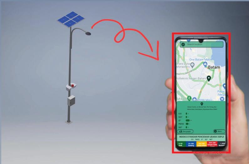
Untuk mengoperasikan lampu jalan multifungsi ini, Endra dan rekannya menggunakan sistem komunikasi radio frekuensi yang mampu menjangkau area komunikasi sejauh 10 kilometer. Sinyal radio dari perangkat akan diteruskan ke server dan kemudian dipantulkan lagi pada sistem *realtime database* agar data bisa diakses pada monitor aplikasi di layar ponsel.
